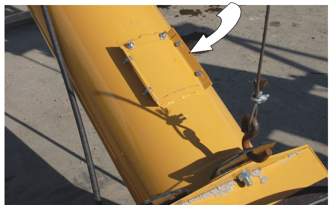
Fig. 32 SWING AUGER ACCESS DOOR
